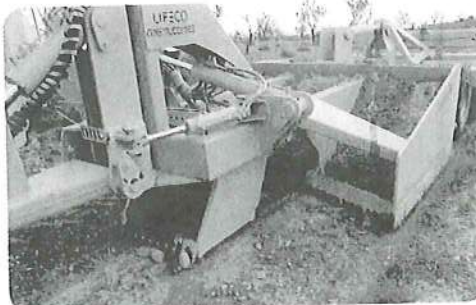
Niveladora Chaptools hace cuatro tareas de forma simultánea; fractura, nivela, compacta y apisona.
